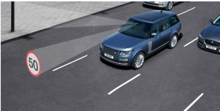
Rozpoznávání dopravního značení s adaptivním omezovačem rychlosti
