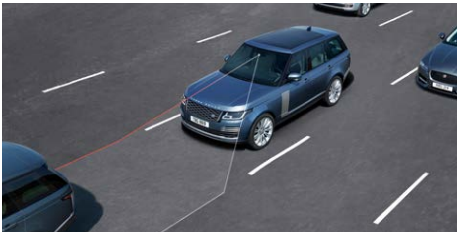
Upozornění na opuštění jízdního pruhu
